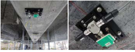
(例) 加速度からたわみを計測
