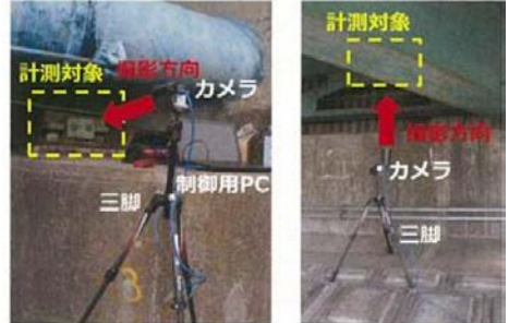
(例) 動画像を解析し変位・回転量を計測
