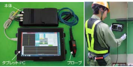
(例) 渦電流探傷法でき裂を判定
