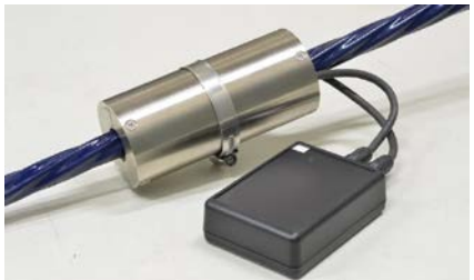
(例) 永久磁石を用いて張力を計測
