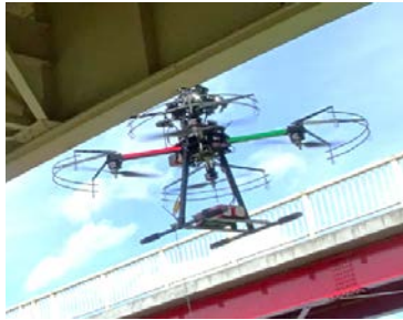
← 橋梁の損傷写真を撮影する技術 【7技術】
