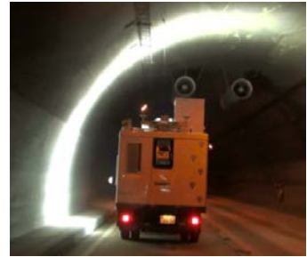
← トンネルの変状写真を撮影する技術 【4技術】
