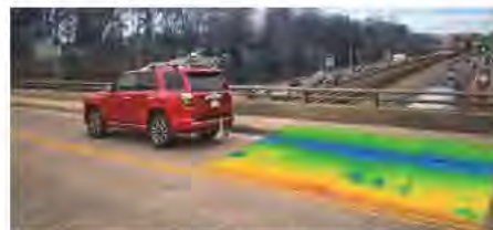
コンクリート床版を赤外線で点検中（イメージ図） NEXCO-West USA, Inc. 松本正人
