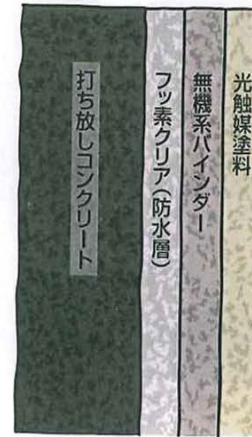
図2-2 一般的な施工法と今回の方法の違い
