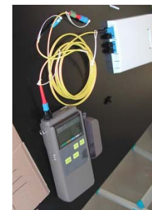
工事終了後、各種試験を実施し、結果報告書として提出。また配線した経路は図面に落とし、完成図書として施設管理者に渡し、以後のメンテナンス資料として、管理。
